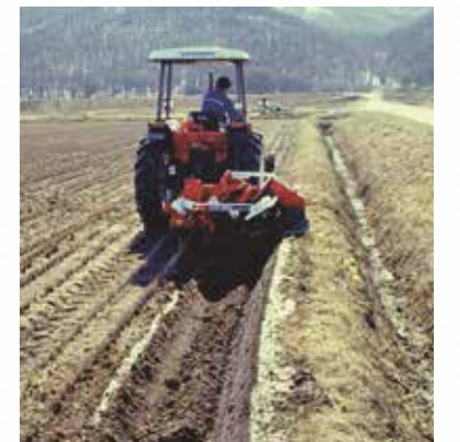
写真 畦塗り施工
