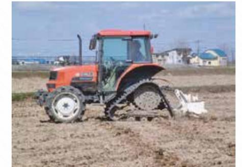
写真 心土破碎（サブソイラ）の施工
