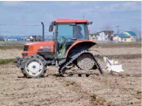
写真 心土破碎(サブソイラ)の施工
