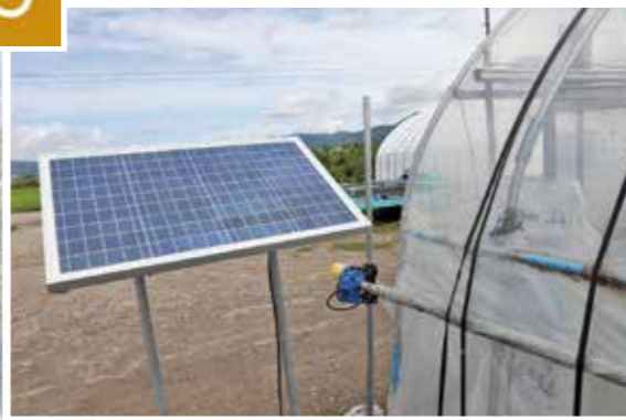
太陽光エネルギーを利用した ビニールハウスの自動巻き上げ機
